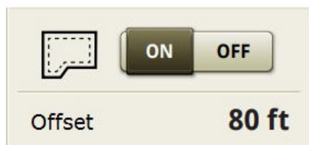
Foragerkontrolenhedskontakt og foragerforskydning
