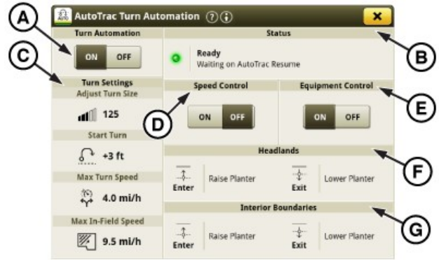
Traktör AutoTrac SıraBaşı Dönüş Otomasyonu Ayarları Sayfası
