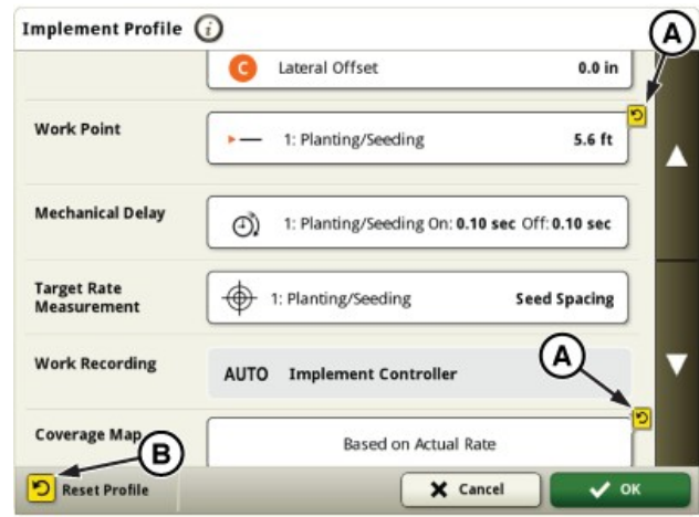
Sıfırlama Düğmesi Konumu
