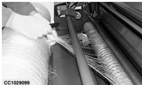
Δίχτυ τυλιγμένο γύρω από τους κυλίνδρους τροφοδοσίας
