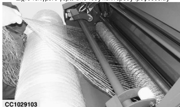
Δίχτυ τυλιγμένο γύρω από τους κυλίνδρους τροφοδοσίας
