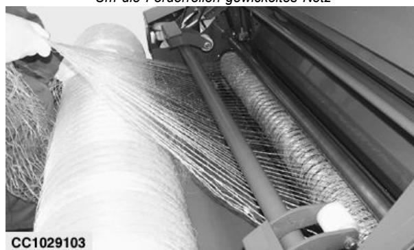
Um die Förderrollen gewickeltes Netz
