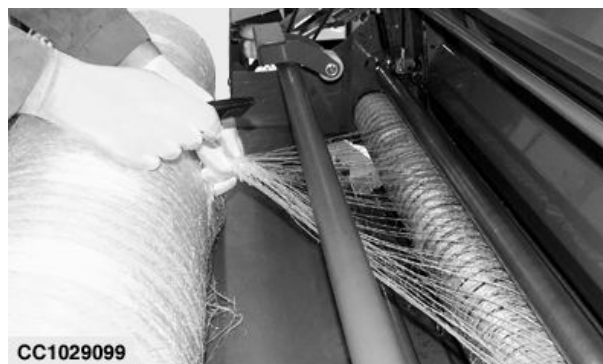
Um die Förderrollen gewickeltes Netz
