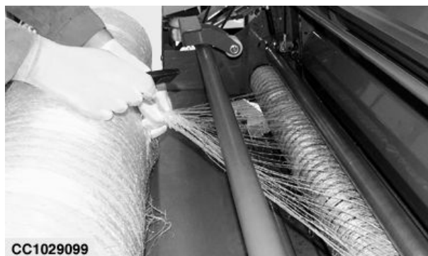
Filet enroulé autour des rouleaux d'alimentation
