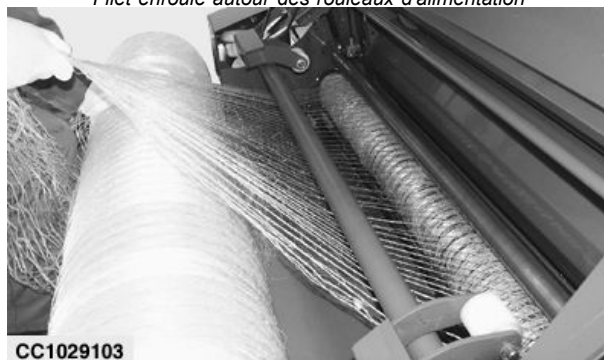
Filet enroulé autour des rouleaux d'alimentation
