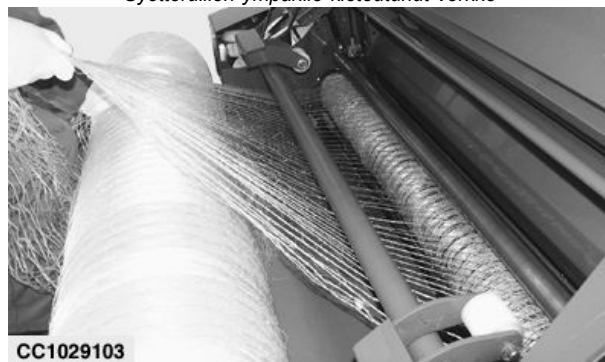
Syöttörullien ympärille kietoutunut verkko
