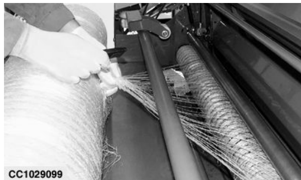
Syöttörullien ympärille kietoutunut verkko
