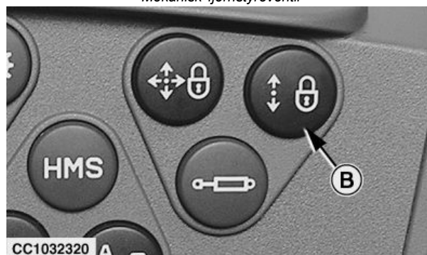
Elektrisk aktiveret fjernstyreventil
