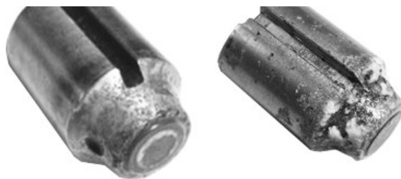
N154836—UN—09MAR21 Közepes korrózió vagy kipattogzás
