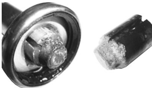
N154837—UN—09MAR21 Erős korrózió vagy kipattogzás
