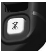
Permetező rendszer főkapcsoló
