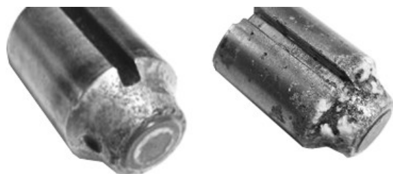
N154836-UN-09MAR21 中程度の腐食とピッチング
