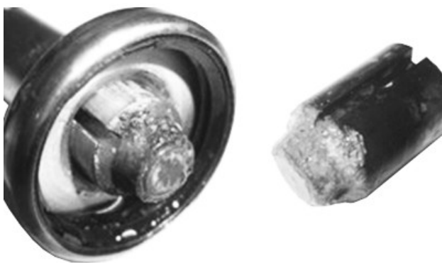
N154837—UN—09MAR21 重い腐食とピッチング
