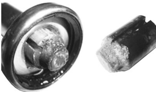
Coroziune și uzură de ciupitură severe
