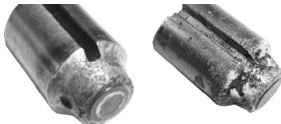
N154836—UN—09MAR21 Közepes korrózió vagy kipattogzás
