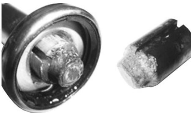
N154837—UN—09MAR21 Corrosión y picado considerables
