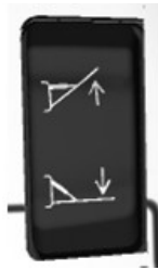
Inclinación de la barra de pulverización del lado derecho
