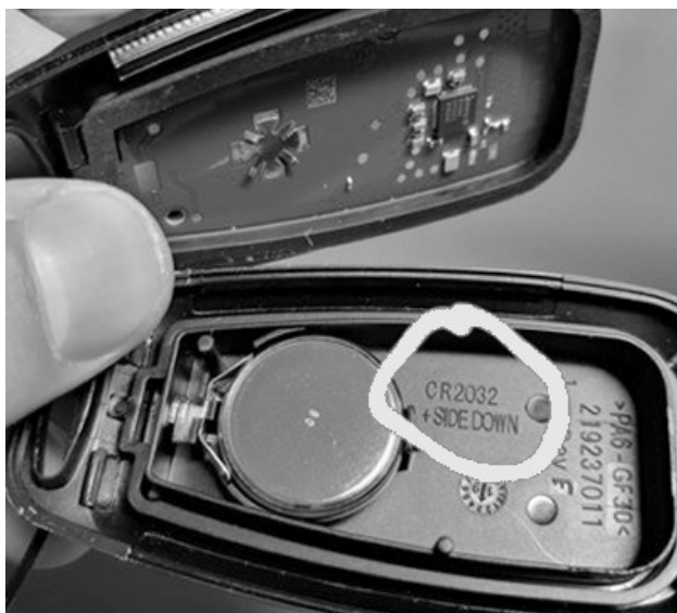
Position correcte de la batterie illustrée
