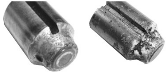
N154836—UN—09MAR21 Corrosion et formation de piqûres modérées
