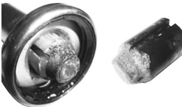
Corrosion et formation de piqûres importantes
