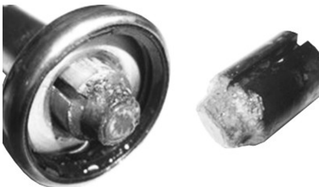
N154837—UN—09MAR21 Силна корозия и образуване на вдлъбнатини по повърхността
