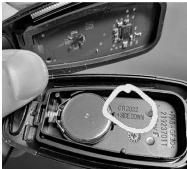
Показано правильное положение аккумулятора
