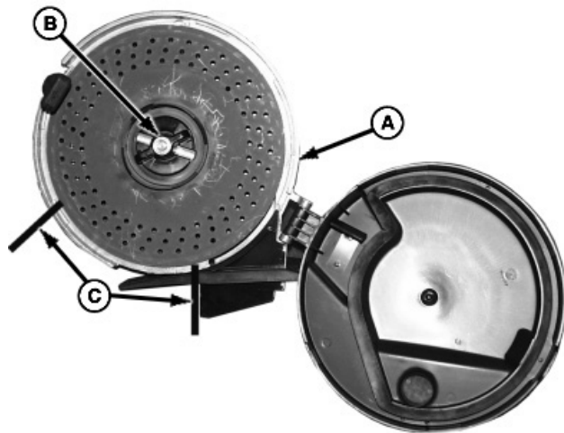
А—Корпус дозатора В—Ручка ступицы С—Сегмент
