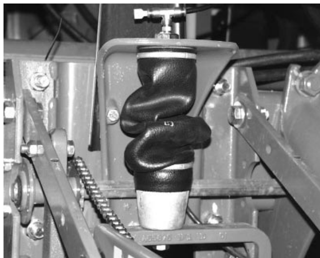
Resorte enrollado incorrectamente
