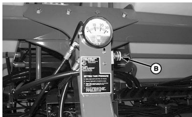
A—Válvula de control de caudal B—Válvula de control de caudal del CCS
