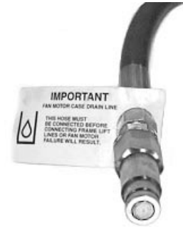
Punta de manguera de vaciado de caja de cierre frontal
