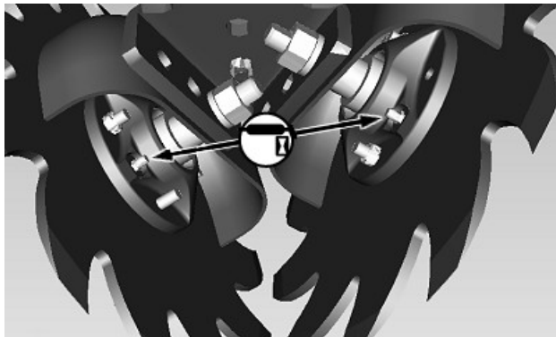
Ступицы очистителей рядков, монтируемые на высевающей секции (вид снизу)
