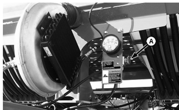
A—Ағынды басқару клапанының тұтқасы
