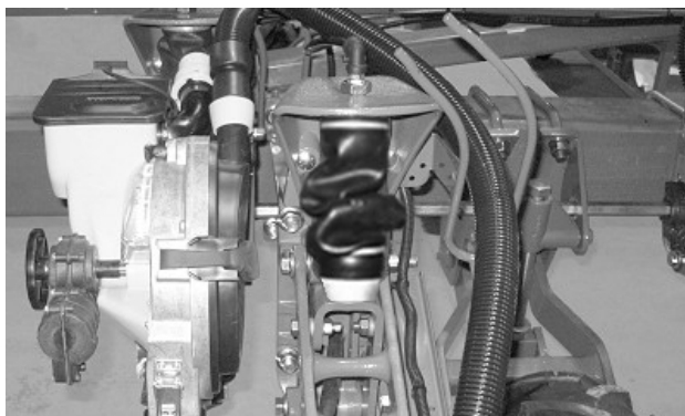
Пневматична пружина встановлена неправильно (просапні сівалки для дворядкового висівання)
