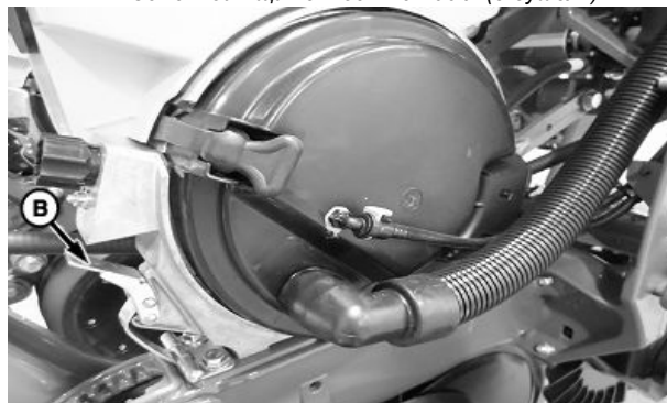
Семенной ящик емкостью 106 л (3 бушеля)
