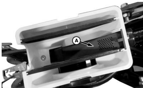
A—Впускное отверстие семенного ящика
