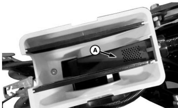
A—Впускное отверстие семенного ящика
