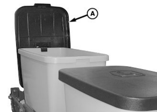
Семенной ящик емкостью 58 л (1,6 бушеля)
