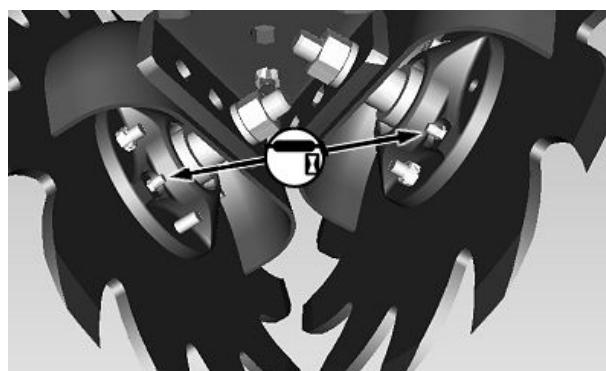
Ступица очистителя рядков, установленного на высевающем аппарате (вид снизу)
