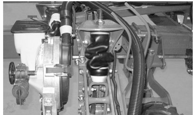
Неправильно расправленная пневматическая пружина (сеялки двухрядного посева)
