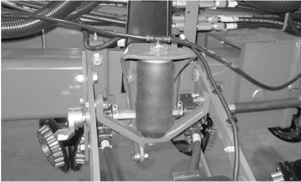
Правильно расправленная пневматическая пружина
