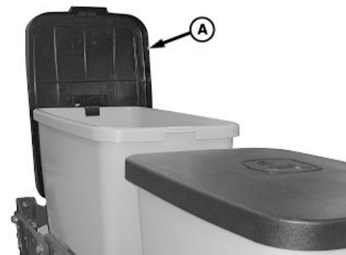
Семенной ящик емкостью 58 л (1,6 бушеля)
