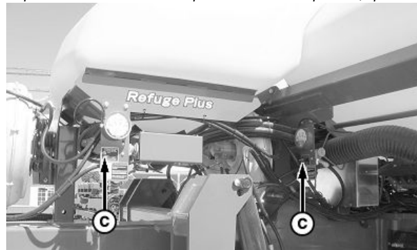
Переключатели вентиляторов CCS DB120
