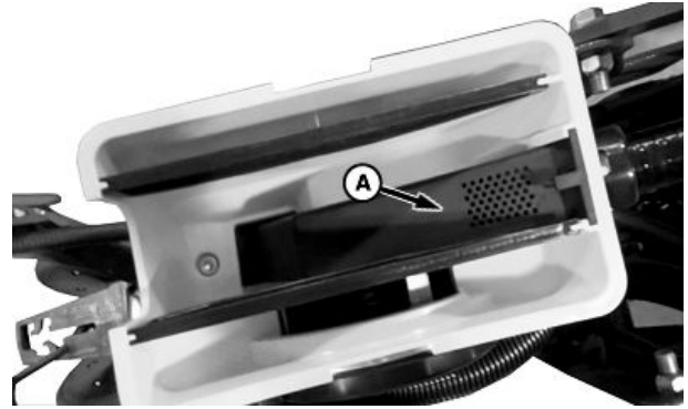
A—Впускное отверстие семенного ящика
