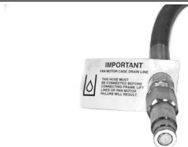
Vârf furtun de evacuare carcasă față încastrată
