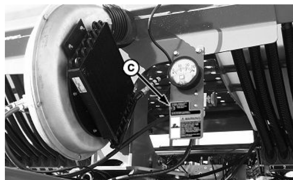
Interruptor del ventilador del CCS
