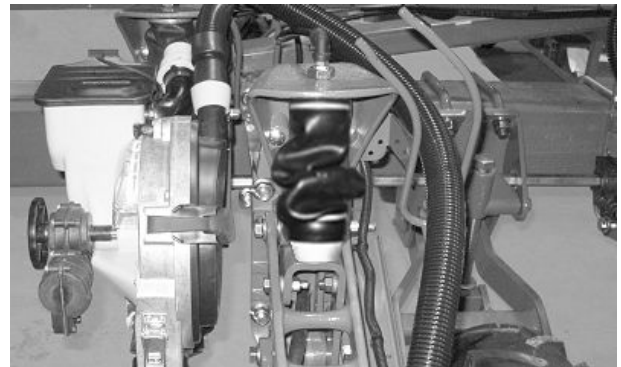
Дұрыс емес оралған пневматикалық серіппе (Егіз қатар сепкіштері)
