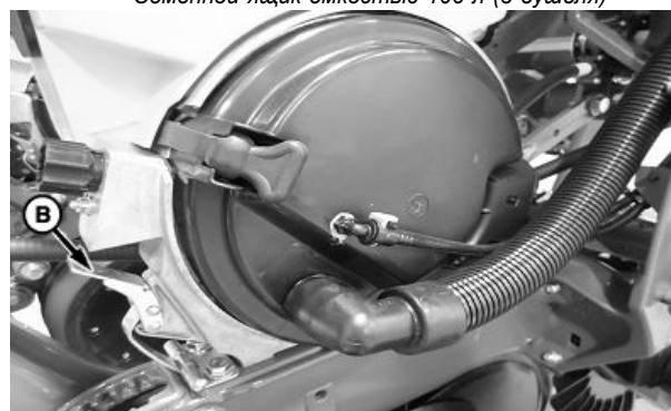
Семенной ящик емкостью 106 л (3 бушеля)
