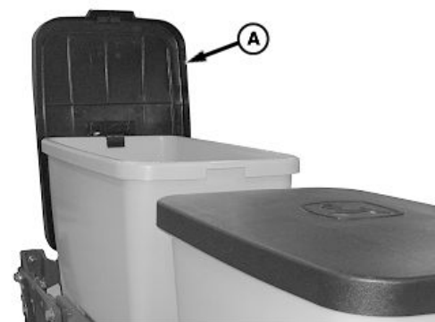
Семенной ящик емкостью 58 л (1,6 бушеля)
