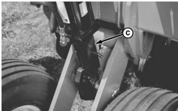
Mecanisme de blocare pentru service roți de aripi
