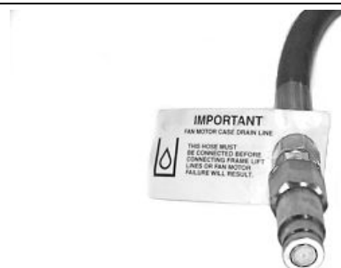
Vârf furtun de evacuare carcasă față încastrată
