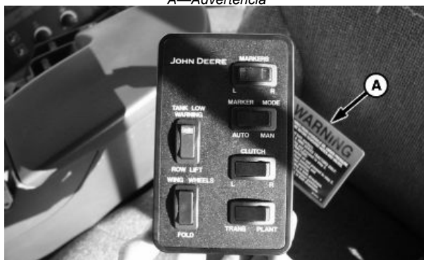
Caja de control del bastidor
