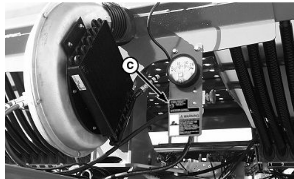
Interruptor del ventilador del CCS
