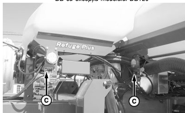
Comutatoarele ventilatoarelor CCS – modelul DB120
