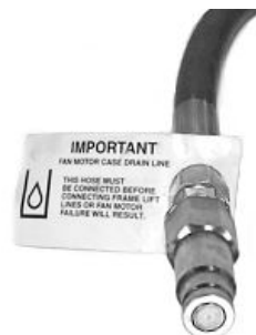
Vârf furtun de evacuare carcasă față încastrată
