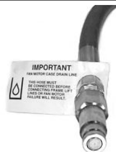
Фитинг сливного шланга корпуса, устанавливаемый заподлицо с внутренней поверхностью
