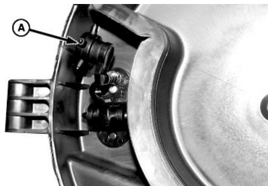
А—Колесико выталкивателя семян
