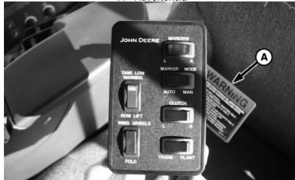
Caja de control del bastidor
