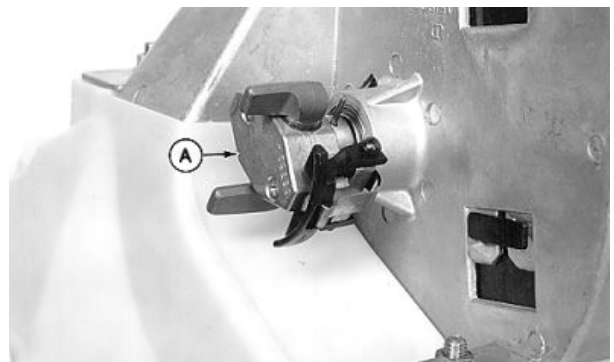
Показан вакуумный дозатор
