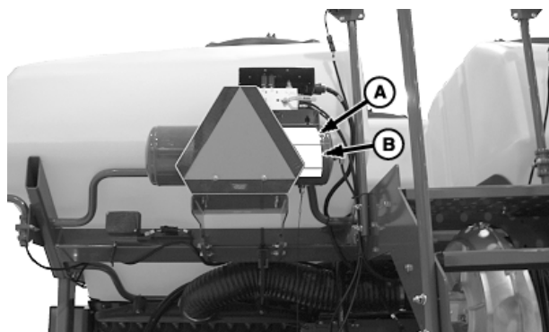
Воздушный ресивер пневматического прижимного устройства
