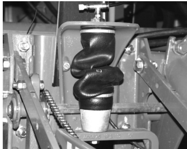
Cojín de aire enrollado incorrectamente
