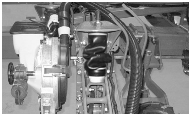
Resort pneumatic rulat necorespunzător (plantatoare cu două rânduri)
