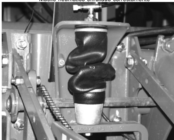
Muelle neumático enrollado incorrectamente
