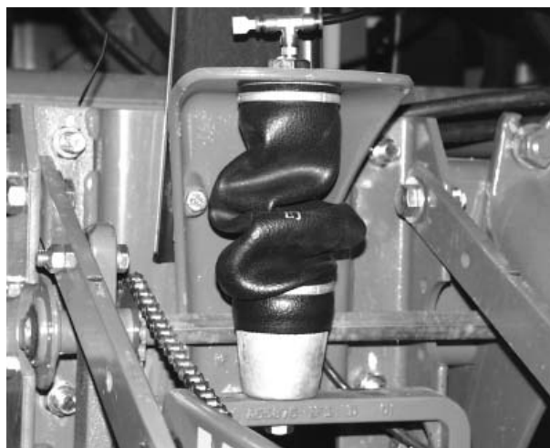
Неправильно расправленная пневмоподушка
