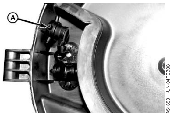
A — Колесико выталкивателя семян
