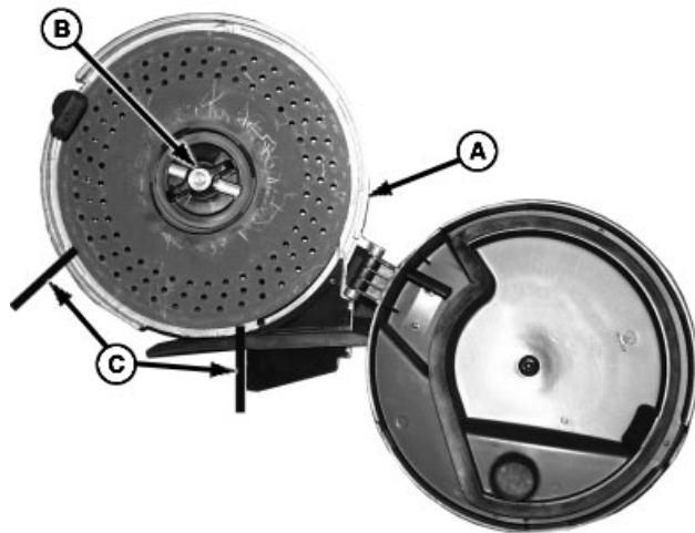
А—Корпус дозатора В—Ручка ступицы С—Сегмент
