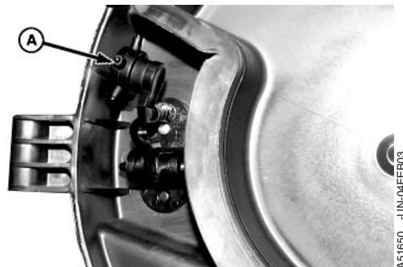
А — Колесико выталкивателя семян
