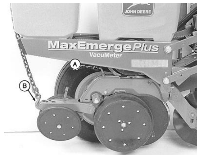
А — Рукоятка регулировки глубины В — Цепочка
