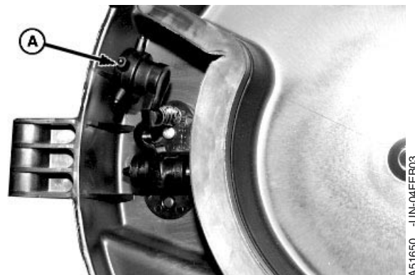
А — Колесико выталкивателя семян
