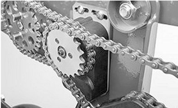
Задвижван с верига съединител MaxEmerge – RowCommand™
