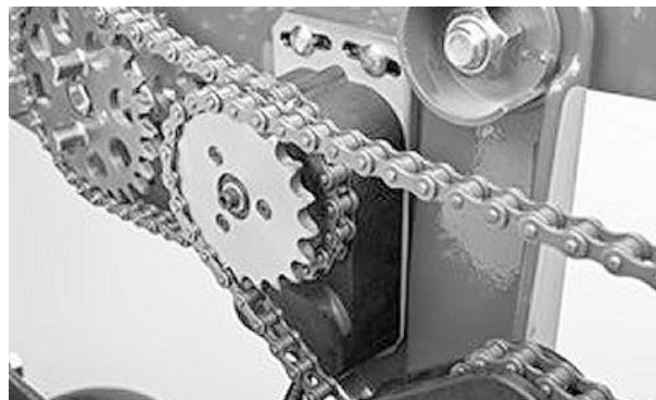
Задвижван с верига съединител MaxEmerge™ на RowCommand™
