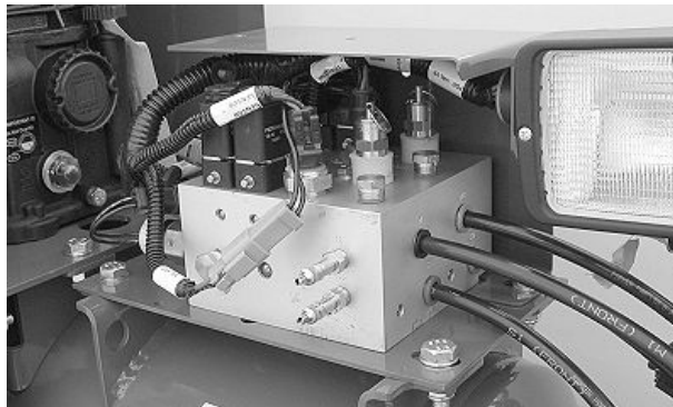
Датчици за налягането на пневматично притискане (Активно притискане) (Показан е клапан с две задания)
