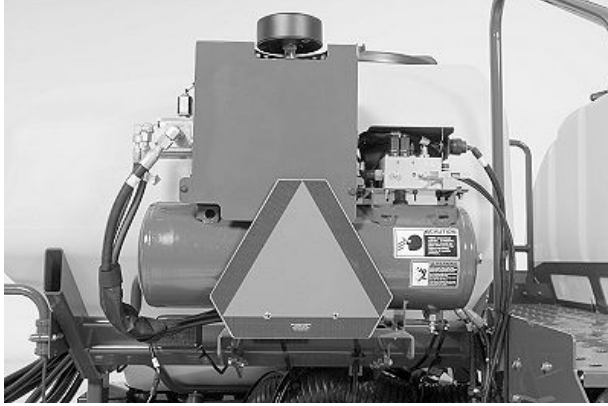
Zračni kompresor pneumatskog pritiskanja, zračni spremnik i elektromagnetski regulacijski ventil – vučene sijačice s CCS (dvostruka točka postavljanja i aktivna sila pritiskanja)
