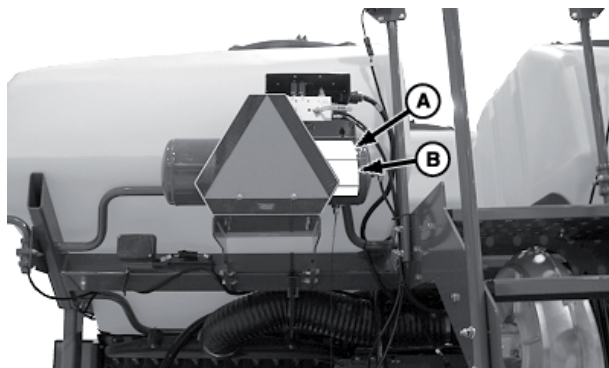
空気圧式下向き力エアタンク：牽引式播種機（単一設定点下向き力）
