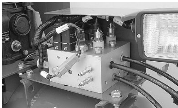
Senzori de presiune ai sistemului pneumatic de deportanță (deportanță activă) (ventil cu valoare setată dublă în imagine)
