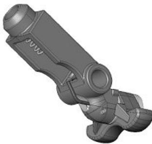
Senzor de deportanță a roților de calibr
