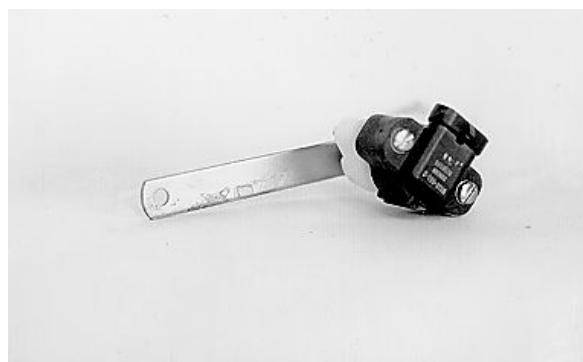
Senzor de înălțime pentru plantatoare tractate
