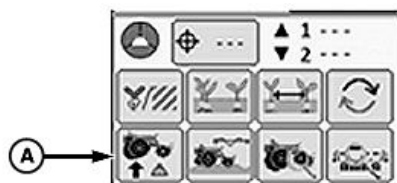
Butonul Deportanță (PDF activă cu doi senzori)
