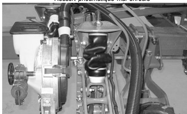
Ressort pneumatique mal enroulé (rangs jumelés)
