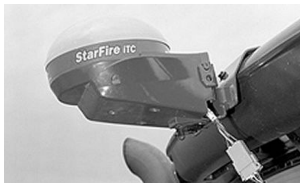
Récepteur GPS (système de positionnement par satellites)
