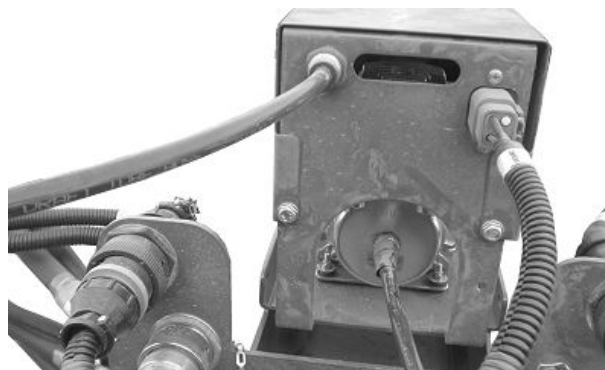
Compresseur d'air de pression pneumatique vers le bas (machines avec pression pneumatique vers le bas intégrée et point de consigne unique)
