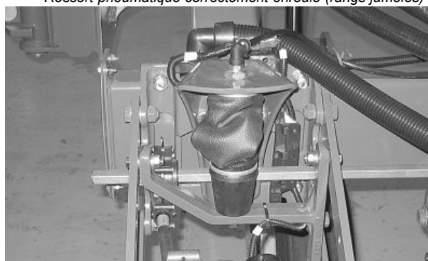
Ressort pneumatique mal enroulé
