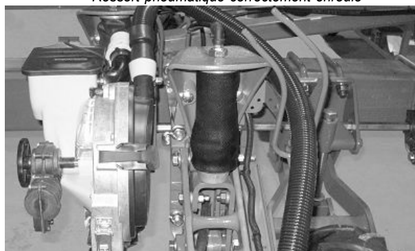
Ressort pneumatique correctement enroulé (rangs jumelés)
