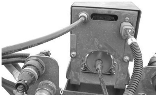
Пневматикалық басу күшінің ауа компрессоры (Жалғыз белгіленген біріккен пневматикалық басу күші бар машиналар)
