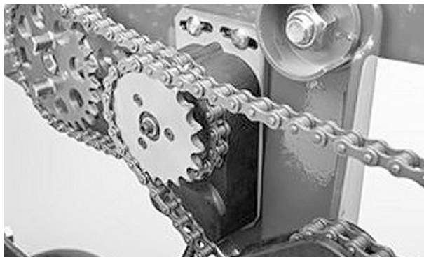
MaxEmerge™ шынжырымен жетектелетін RowCommand™ муфтасы
