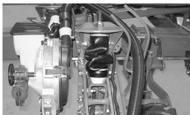
Дұрыс емес оралған пневматикалық серіппе (Егіз қатар сепкіштері)
