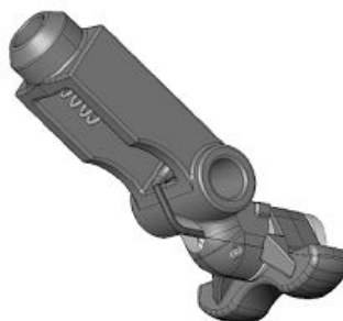
Қатар доңғалақтарының басу күші датчигі
