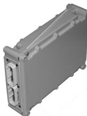
24 қатардан көп машиналардағы екінші дән монитормы/құбылмалы мөлшер жетегінің контроллері
