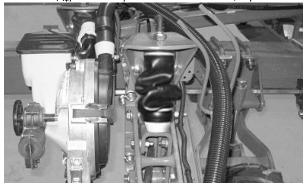
Дұрыс емес оралған пневматикалық серіппе (Егіз қатар)
