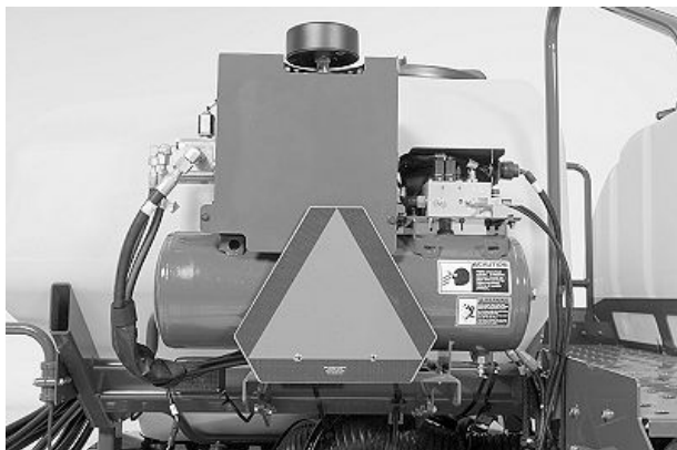
Пневматикалық басу күшінің ауа компрессоры, ауа бағы және соленоидты басқару клапаны - ОӨЖ бар сүйрелетін сепкіштер (Қос белгіленген және белсенді басу күші)
