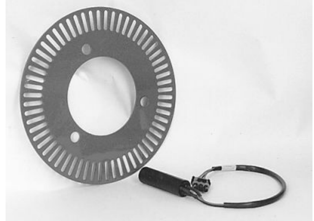
Sensor de movimiento de la tracción delantera de proporción variable
