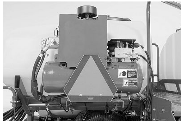
Compresor de contrapresión neumática, depósito de aire y electroválvula de control - Sembradoras remolcadas con CCS (contrapresión activa)
