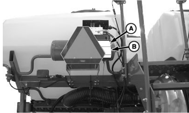
Depósito de aire de contrapresión neumática - Sembradoras arrastradas (contrapresión de punto de ajuste único)
