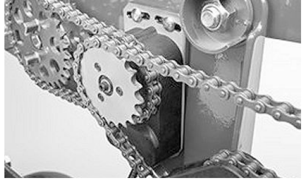
Embrague de una unidad RowCommand™ accionada con cadena en un sistema MaxEmerge™
