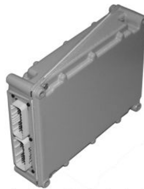
24 Sıradan Fazla Sıralı Makinelerde İkinci Tohum Monitörü/Değiştirilen Oranlı Tahrik Kontrolörü
