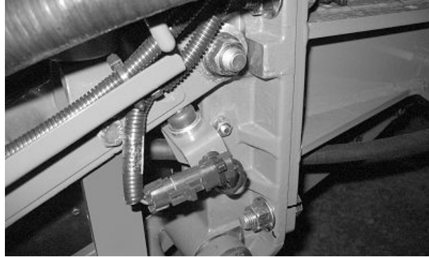
İkiz Sıralı Entegre Ekim Makineleri için Paralel Kol Yükseklik Anahtarı
