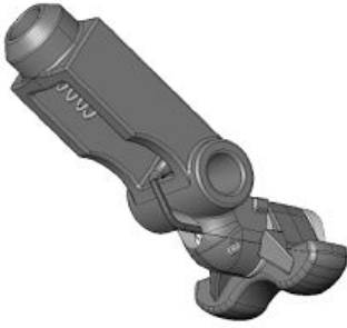
Ölçüm Tekerleği Düşey Kuvvet Sensörü
