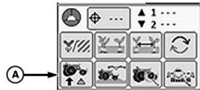
Düşey Kuvvet Düğmesi (Etkin PDF İki Sensör)
