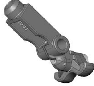
Ölçüm Tekerleği Düşey Kuvvet Sensörü
