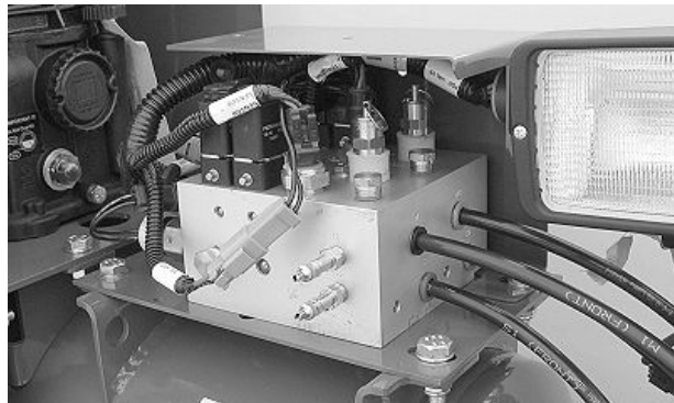
Pnömatik Düşey Kuvvet Basınç Sensörleri (Etkin Düşey Kuvvet) (Çift Ayar Noktalı Valf Gösterilmektedir)
