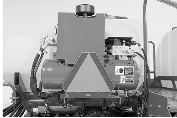
Pnömatik Düşey Kuvvet Hava Kompresörü, Hava Deposu ve Solenoid Kumanda Valfi - CCS'li, Çekilen Ekim Makineleri (Etkin Düşey Kuvvet)
