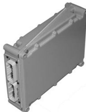
Unidad de control electrónico Sembradora principal 1 (PM1)
