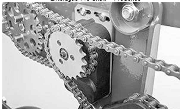
Embrague accionado por cadena MaxEmerge™ XP
