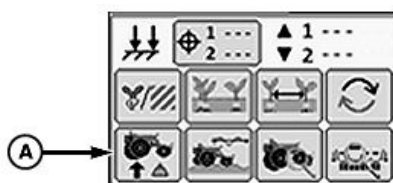
Botón de contrapresión (PDF con punto de ajuste doble)
