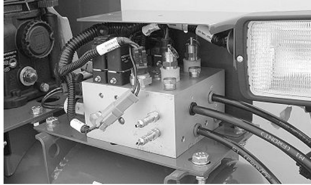
Sensores de presión de contrapresión neumática (Contrapresión activa) (Se ilustra la válvula con punto de ajuste doble)
